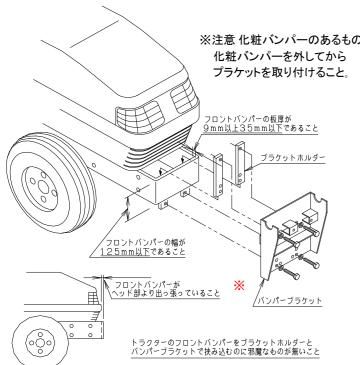
※UX,UH140Fについては、フロントバンパーの厚みが9mm以下 の場合、トラクターが変形する恐れがあるので御注意ください。
