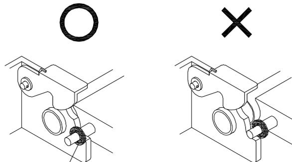
ツバが抜け止めされるところまで肥料載せ台を差し込む
