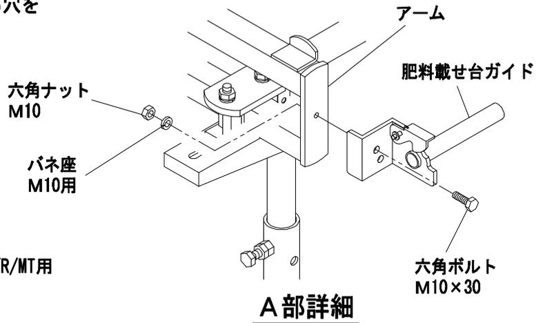
(2) 肥料載せ台ガイドのフックを持ち上げ、肥料載せ台ガイドの切り欠き(図B
