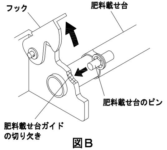
※ 肥料載せ台のピンのツバが抜け止めされるところまで、肥料載せ台を差し込んで下さい。
